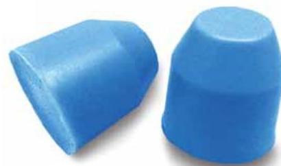
**STOPSAL TUBE** è una chiusura in gomma poliuretanicamente espansiva di colore blu per la sigillatura dei fori dei distanziatori dei casseri. E' privo di bentonite e di altri additivi idroespansivi. Inserito nei fori, si espande in contatto con acqua sigillando il passaggio di acqua.
